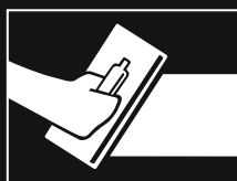
Aplicar de la parte alta del muro, dejando un espesor ligeramente mayor al tamaño del grano.
